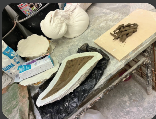
Vyroba sadrovej formy na hlinený základ
