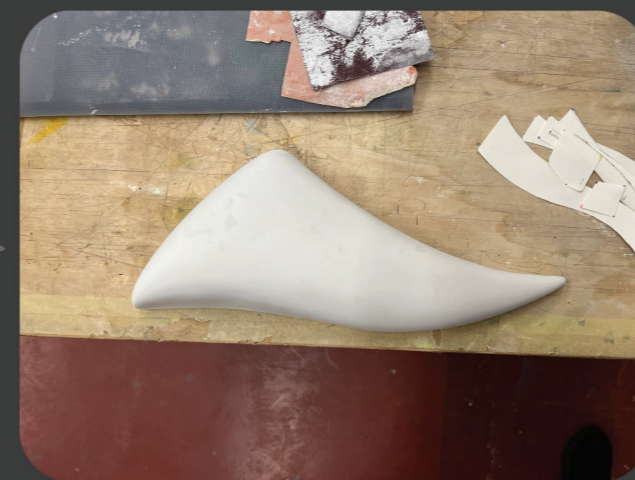
Vybrúsený sadrový model na ohýbanie plexiskla
