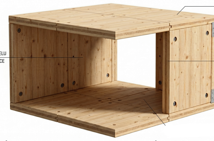
SPALNÉ PANELE ROZKOVÁ VÝZTUŽ KONSTRUKČNÍ ŠROUBY KOVANÉ
